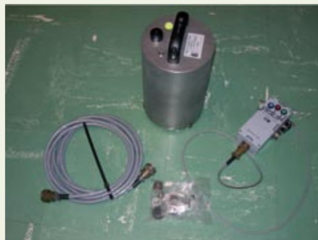
GURALP-seismometer met kabels en aftakingsdoos. Sismomètre GURALP avec ses câbles et boîte de dérivation. GURALP seismometer with its cables and branch box.
